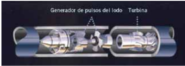
Figura 1. MWD (Measuring While Drilling) indicador del la inclinación y la orientación ( acimut ) de la columna perforadora.
